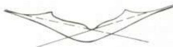
Impugnatura deflessa: i prolungamenti della faccia anteriore dei flettenti si congiungono in prossimità del pivot point.
